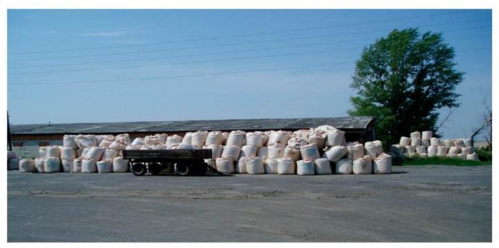
Рис. 15.22. Факт ненадлежащего хранения аммиачной селитры под открытым небом, на грунте, без поддонов
