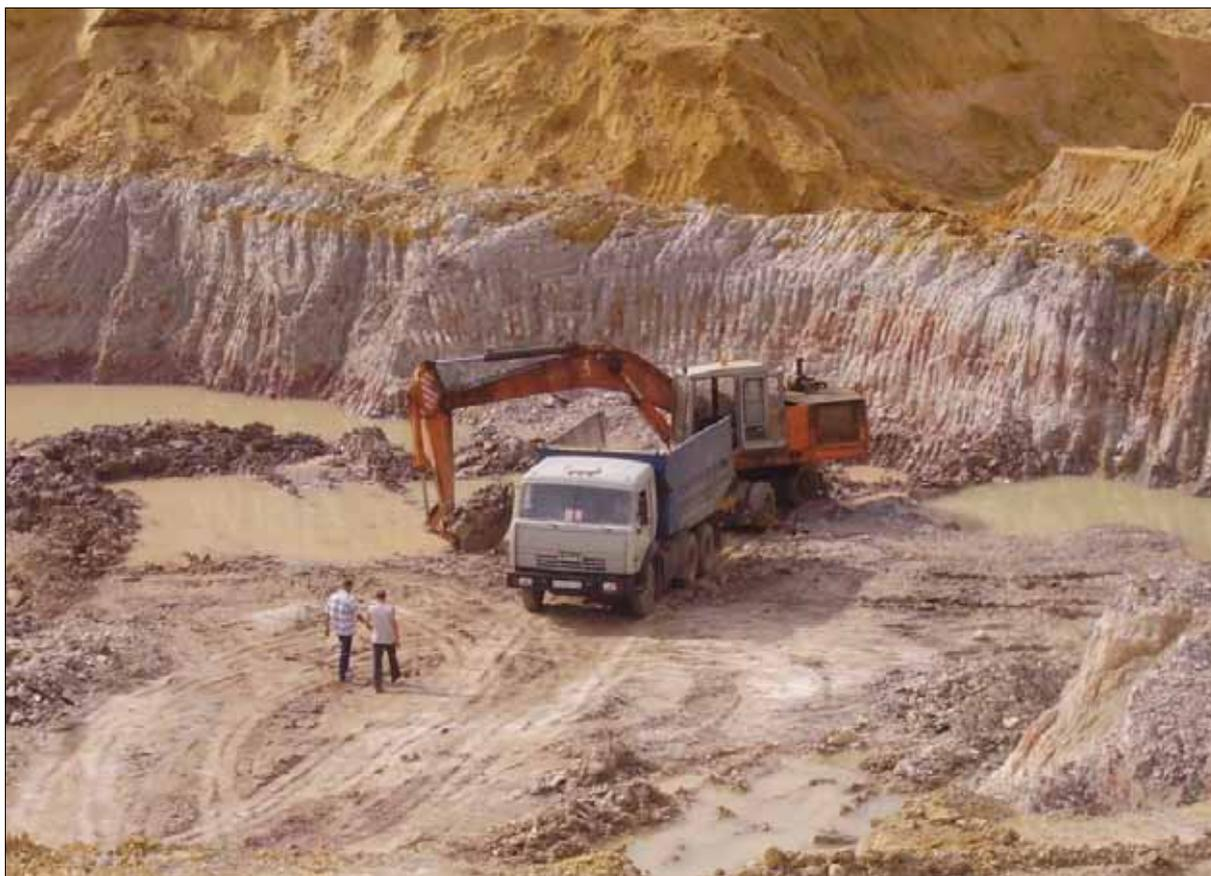
**Рис. 1.4.5. Добыча тугоплавких глин на месторождении «Большая Карповка»**
