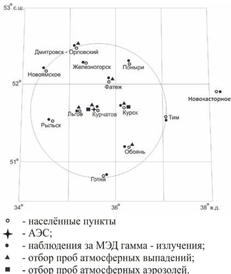
Рис. 3.1. Расположение пунктов радиационного контроля в Курской области в 100-километровой зоне Курской АЭС
