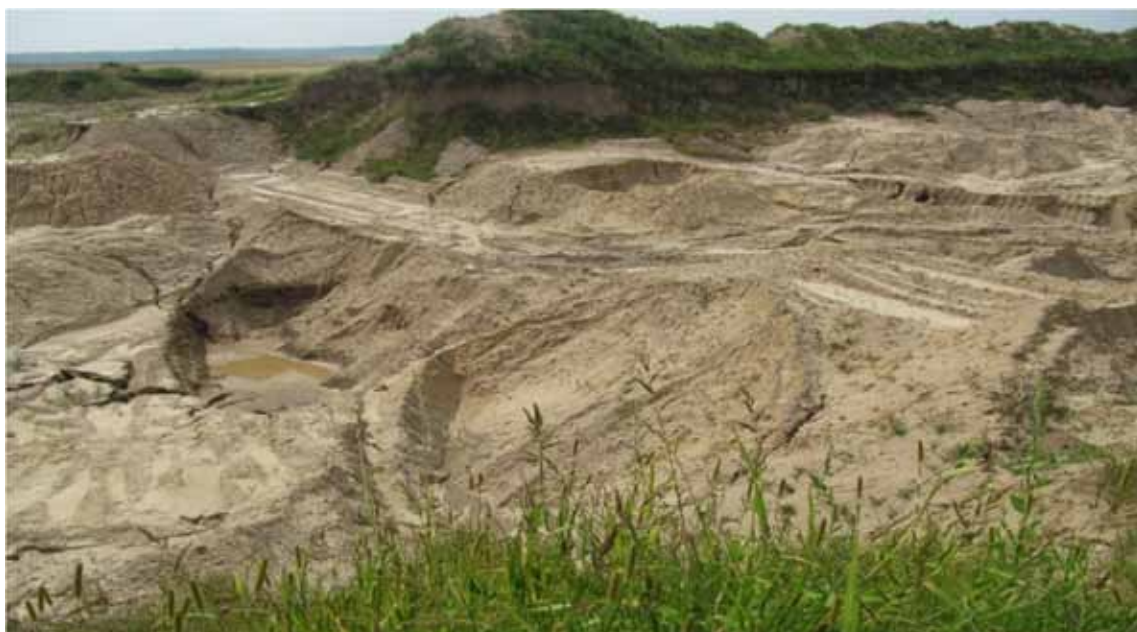
Рис. 15.4. Уничтожение плодородного слоя почвы путем его перекрытия вскрышными породами на земельном участке, расположенном на территории Конышевского района
