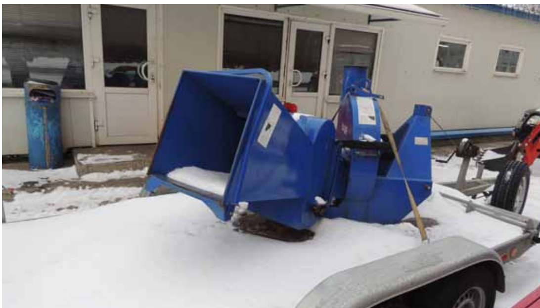
Рис. 12.8. Дробилка для переработки спиленных и опавших веток в щепу
