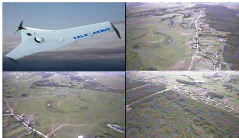
*Рис. 4.5.4. Проведение авиаразведки с использованием БПЛА*
